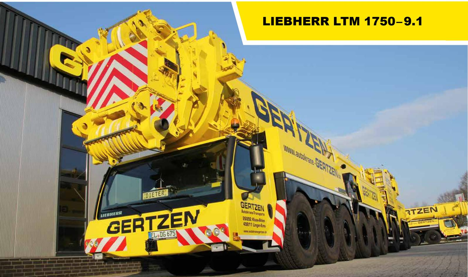
Dieser Liebherr-Mobilkran ist auf sehr kurze Rüstzeiten ausgelegt. Er besitzt eine hohe Tragkraft und kann mit verschiedenen Auslegersystemen versehen werden. Der 9-achsige Kran ist in der Lage seinen kompletten Teleskopausleger im Straßenverkehr mitzuführen. Durch die modifizierte Leerfahrtkonfiguration reduziert sich das Gesamtgewicht auf nur 99 Tonnen. Hubarbeiten sind auch mit einer Abstützbasis von 10 x 10 m möglich.
