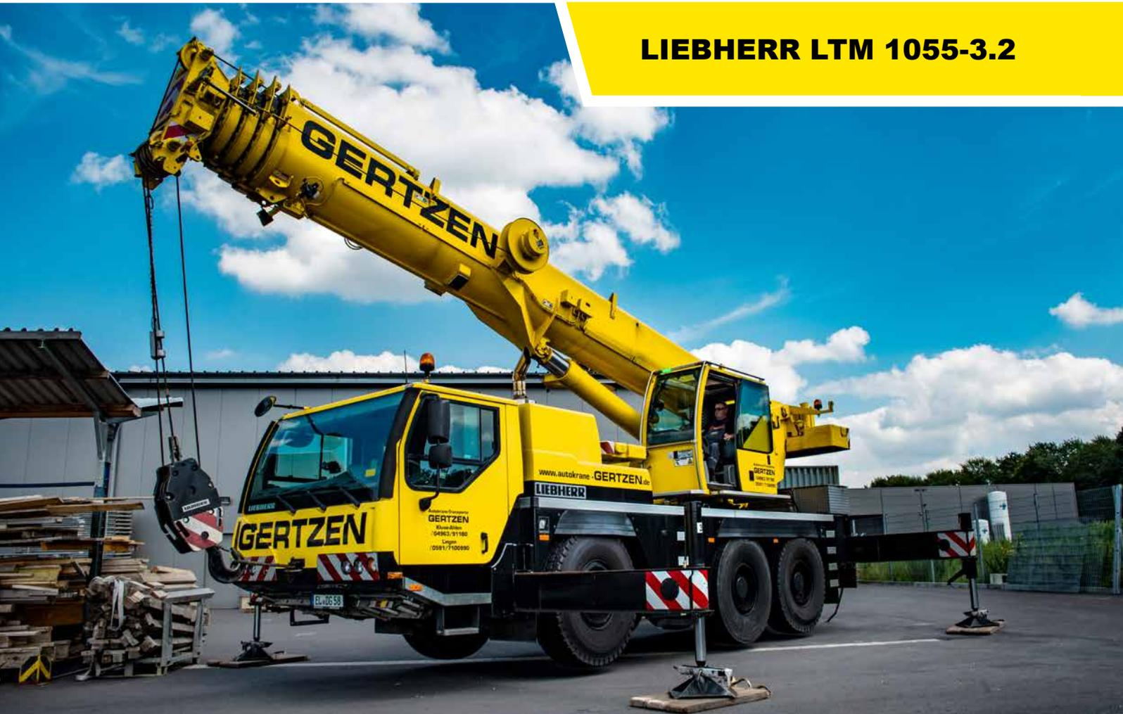
Auf drei Achsen montiert bietet der 1055-3.2 eine hohe Flexibilität, wenn es um Spitzenträgerkräfte mit Vollballast und Teilballast geht. Eine moderne Abstüznivellierung und Aufballastierung sorgt für eine schnelle Einsatzbereitschaft.
