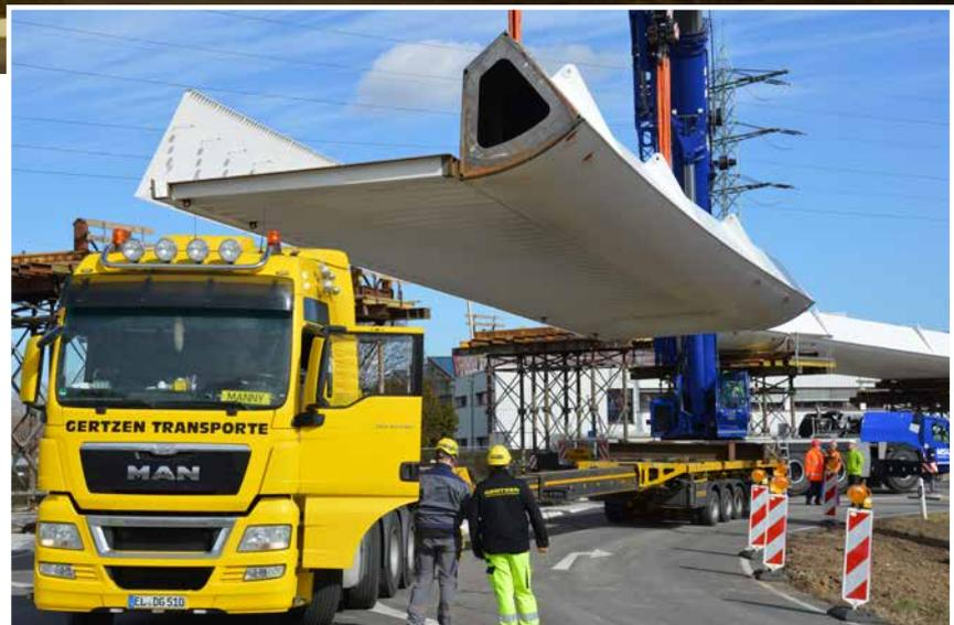
Telesattelaufleger, wie dieser 3-fach teleskopierbare Trailer sind Spezialisten besonders für lange Ladungen. Mit einer nutzbaren Länge zwischen 17 m – 48 m. Eingesetzt in verschiedenen Branchen, wenn es um lange Projektladungen geht. Zudem wird durch die Anzahl von sechs 10 to Achsen die Nutzlast im Telesattel-Bereich signifikant erhöht. Hierdurch lassen sich auch lange Ladungen mit hohem Gewicht problemlos transportieren.
